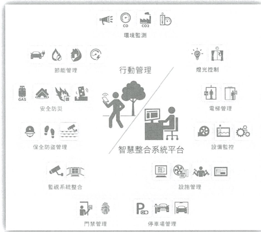
圖 4 系統整合架構示意圖
