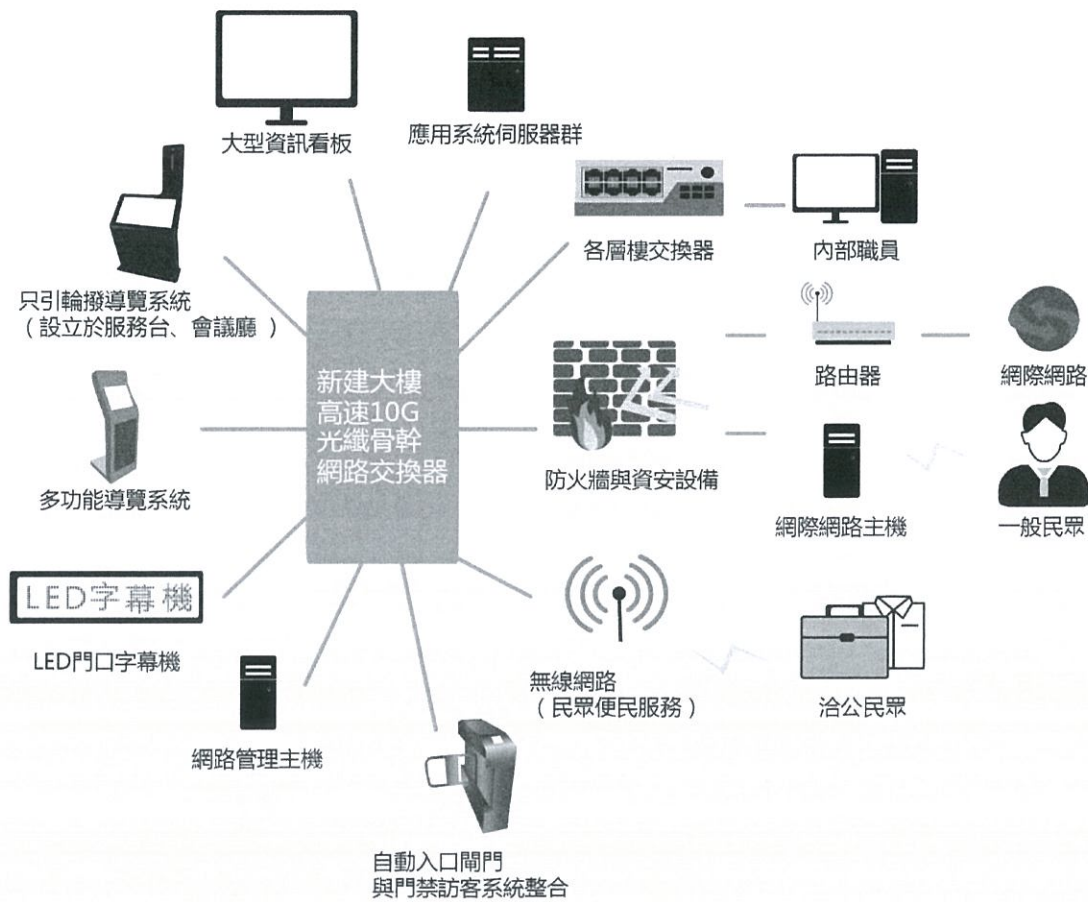
圖 2 總合佈線架構概念說明示意圖
